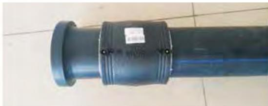
**Hızalama:** İyi bir kaynak işlemi gerçekleştirmek için borular ve ek parçalar manşon ile düzgün bir şekilde hizalanmalıdır. Kaynak sırasında, ısıtma ve soğutma süreçlerinde, borular asla oynatılmamalı ve yerleri değiştirilmemelidir. Bu nedenle, kaynak ve soğutma işlemi sırasında bu tür hareketlerden kaçınmak için, manşon boruya ve ek parça kelepçe ile sabitlenmelidir.
