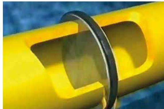
Tıraşlanan kaynak bölgeleri kirletilmemeli, el ile doku-nulmamalıdır. Aksi takdirde tekrar tıraşlama yapmak şarttır. Kaynak bölgesinde tıraşlama sonucunda ortaya çıkan çapaklar birleşme yüzeylerinden el değmeden temizlenmelidir.
