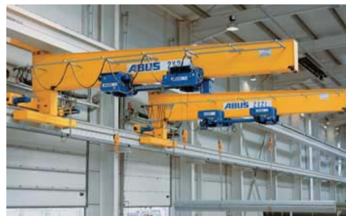
ABUS EKL wall travelling crane carrying a long load (Rösta)
